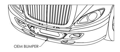
2. REMOVE THE TWO SETS OF FASTENERS ON EACH SIDE OF THE FRAME SHOWN IN THE FIGURE ON THE RIGHT.
